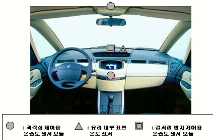
그림 4. 온습도센서 모듈 및 온도센서 설치 위치
